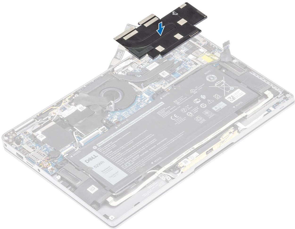
4. Far aderire le lamine di metallo alla protezione del dissipatore.
