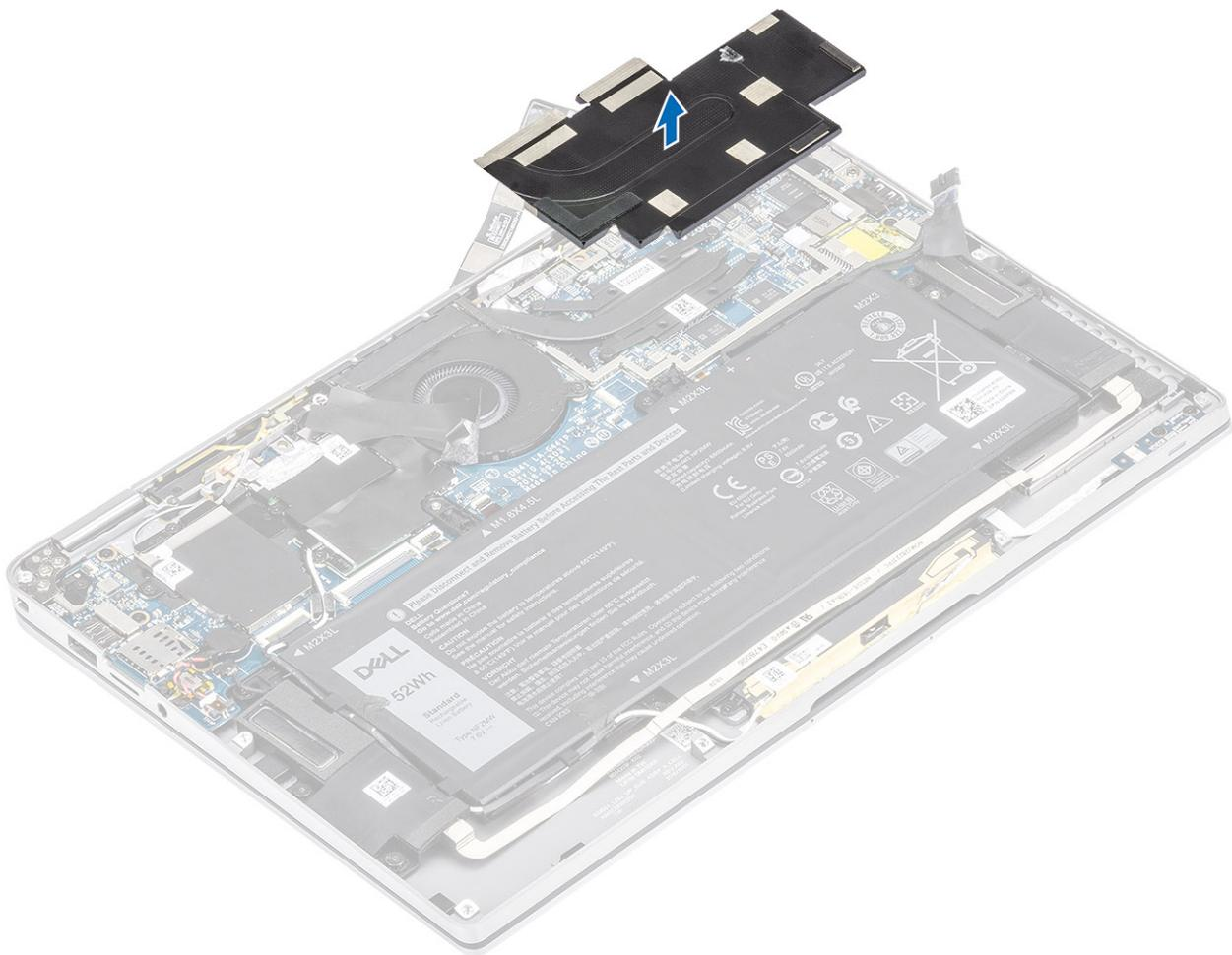
6. Rimuovere le quattro viti (M1.6x2.5) [1] che fissano il dissipatore di calore alla scheda di sistema.
